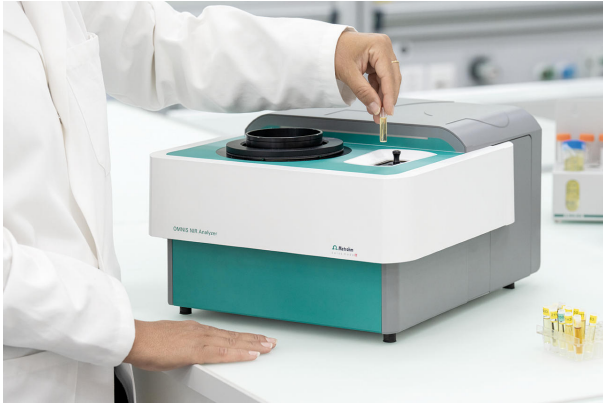
Figure 1. Analyseur NIR OMNIS et un échantillon rempli dans un flacon jetable.
