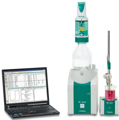
Figure 1. 907 Titrand avec tiamo. Exemple de montage pour la détermination photométrique de la vitamine C.
