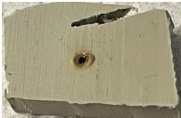
Figure 5. Ejemplo de quemado de muestra con un sistema de 1064 nm. Este material se identificó como éter de polifenileno (PPE) con MIRA XTR DS.
