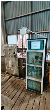
Figure 2. Analizador de Procesos 2060 TI con panel de preacondicionamiento en planta de refinación de zinc.
