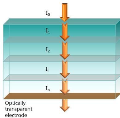
**Figure 1.** Configuración de transmisión normal.
