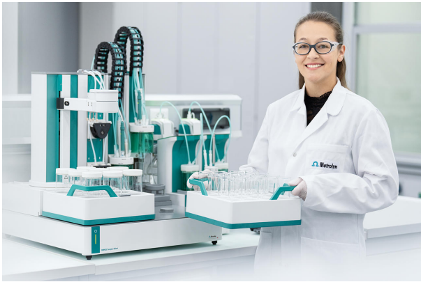
Figure 1. Robot de muestreo OMNIS y titulador avanzado OMNIS equipados con un electrodo dUnitrode y tapas Disc-Cover.
