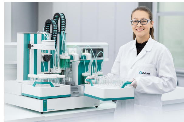
Figura 1. OMNIS Sample Robot S – WSM equipado con un titulador OMNIS, módulos de dosificación y un electrodo selectivo de cobre para la determinación automatizada de muestras de tierras raras.
