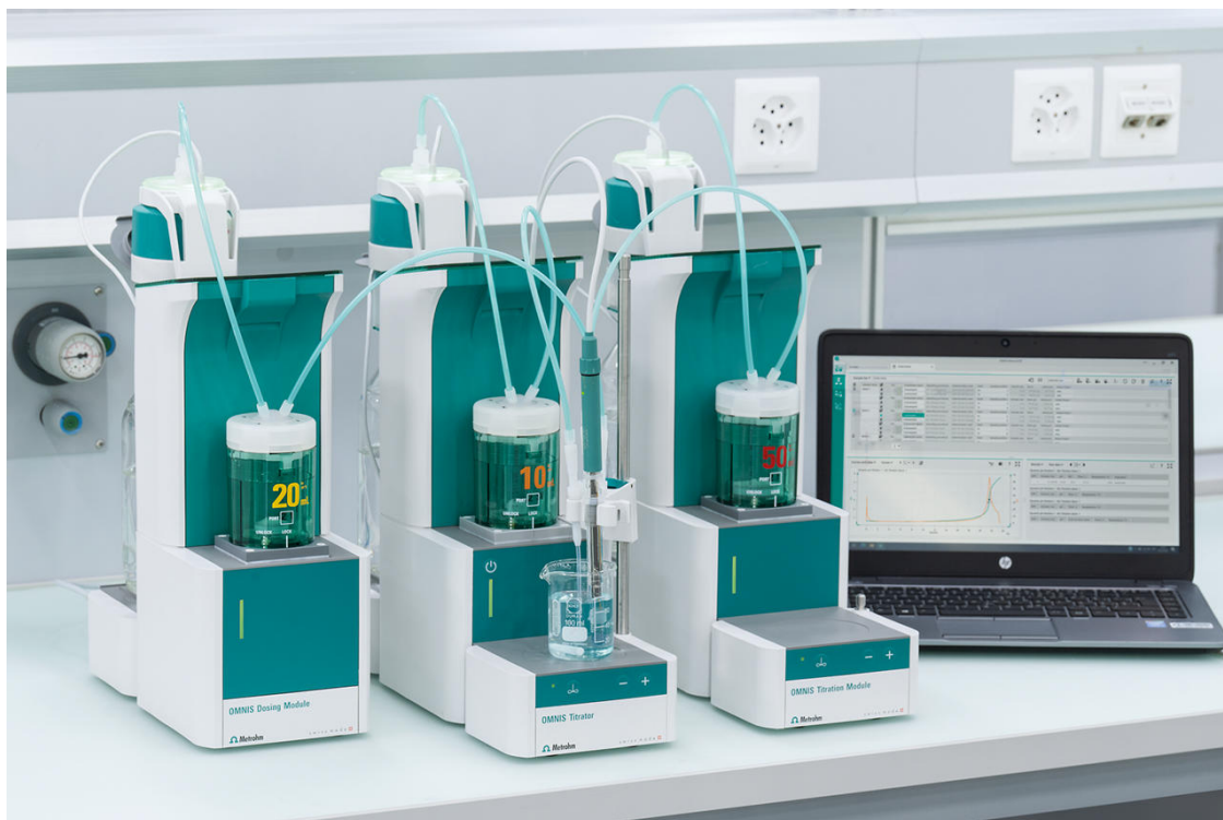
Figura 2. Valorador OMNIS equipado con un electrodo dSolvotrode para la determinación del contenido de cafeína en muestras no acuosas.
