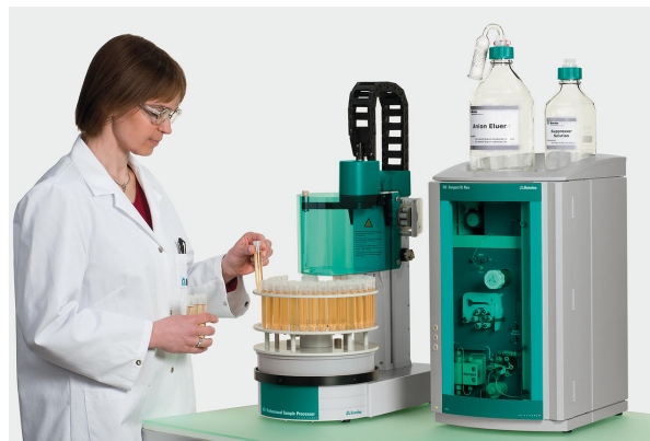
Figure 1. Instrumentación IC de Metrohm compacta y fácil de usar para cuantificar oxihaluros además de aniones estándar en agua potable.
