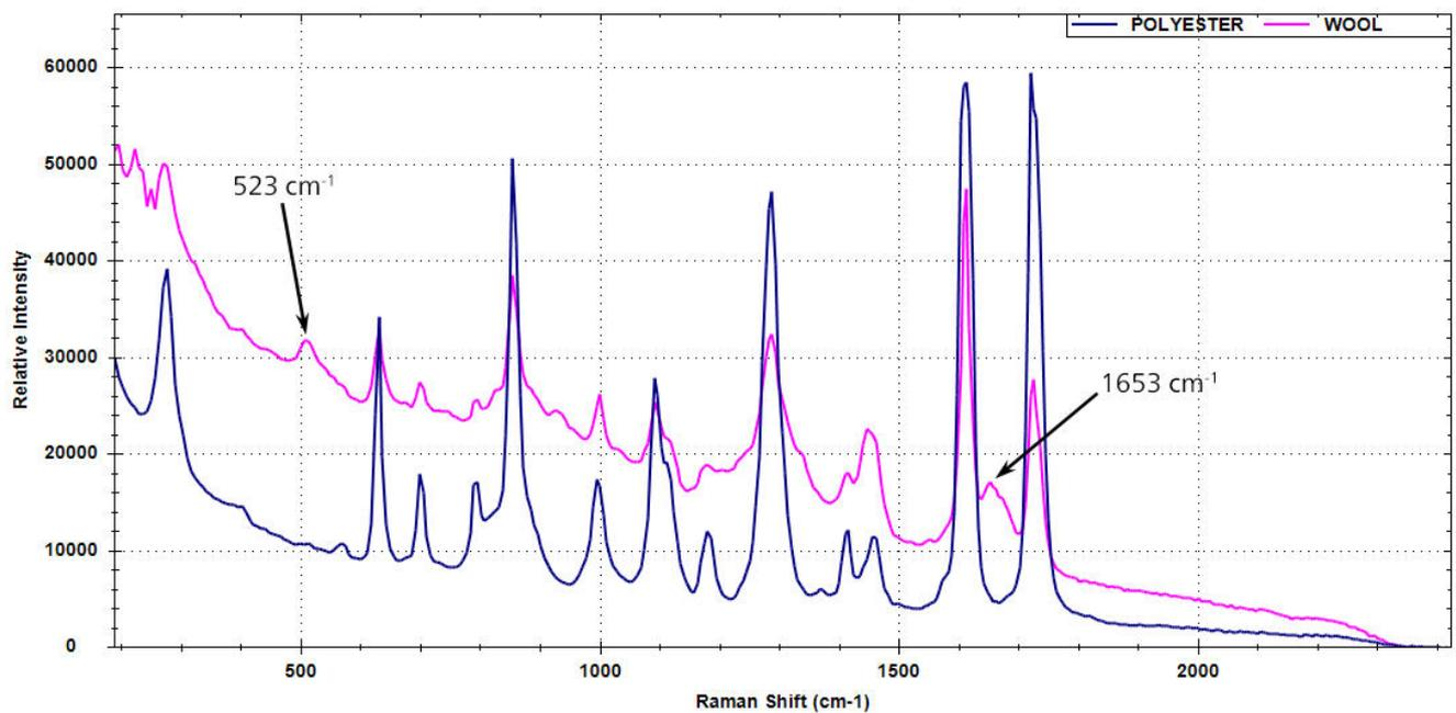
Figure 2. Superposición de espectros para lana y poliéster.
