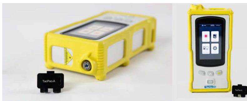
Figure 2. Espectrómetro Raman portátil TacticID con excitación láser de 785 nm y adaptador TacPac
