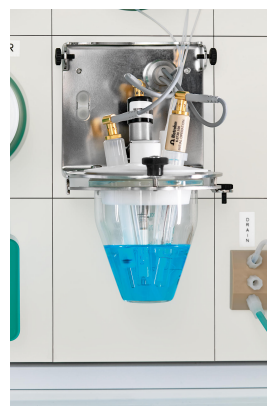
Figure 3. Primer plano de la celda electroquímica del analizador de procesos CVS 2060.
