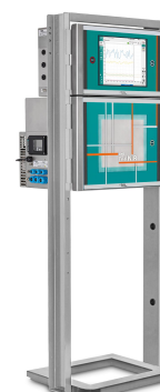
Figura 2. El analizador NIR-Ex 2060 de Metrohm Process Analytics puede medir el % de NCO en el proceso de producción de PU casi en tiempo real.
