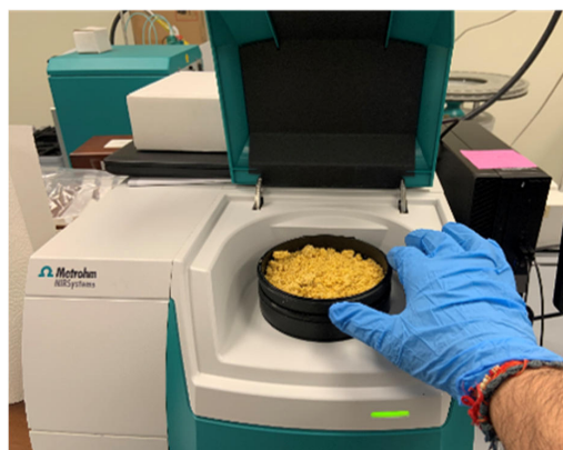
Figure 1. Muestra de macerado de fermentación colocada en el analizador de sólidos DS2500.
