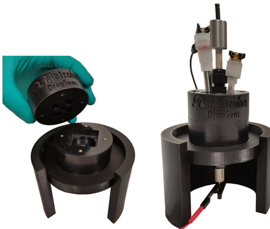
Figure 1. REFLECELL-C, la célula UV-Vis para electrodos convencionales. Vista interior (L) y célula completamente montada con WE, CE, RE y fibra óptica sujeta con pieza de sujeción para un posicionamiento óptico (R).
