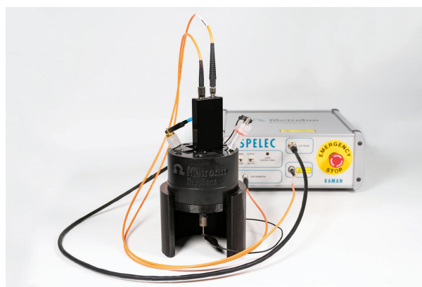
Figura 1. Instrumento SPELEC RAMAN y sonda Raman utilizados en combinación con una celda espectroelectroquímica Raman para electrodos convencionales.
