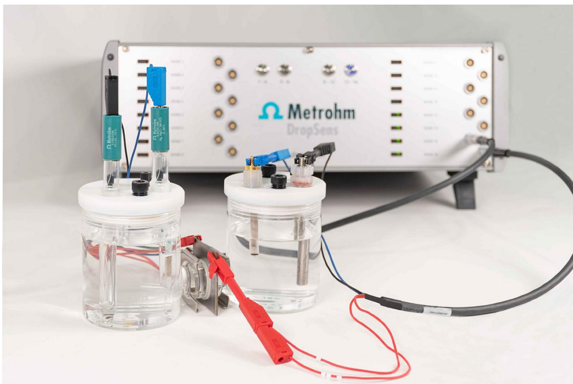
Figure 1. Instrumento \mu Stat-i Multi16 con H-CELL.
