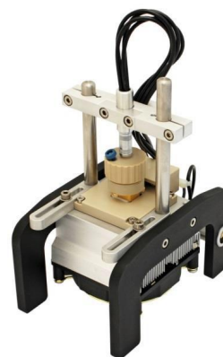
Figure 5. Vista general del soporte de la celda y la celda electroquímica
