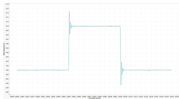
Figura 5. Una medición de retroalimentación positiva del circuito de la Figura 1, celda ficticia (c), con un valor de compensación iR aceptable de 95 \Omega .
