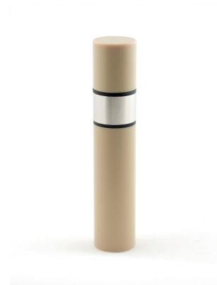
Figure 1. Electrodo de cilindro giratorio que muestra el inserto metálico, las juntas tóricas de Viton (negras) y el soporte de PEEK.
