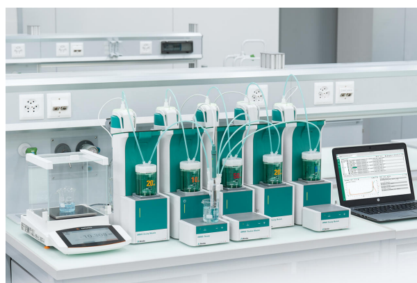
Figura 1. Cuando se equipa con un Optrode M2, el titulador OMNIS Professional con módulos de dosificación OMNIS (que se muestra aquí) constituye una configuración ideal para la determinación de metales de tierras raras.
