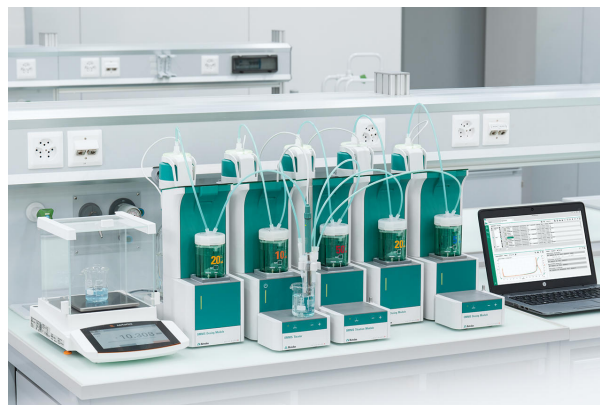
Figure 1. Cuando está equipado con un Optrode M2, el titulador profesional OMNIS con módulos de dosificación OMNIS (mostrados aquí) es ideal para la determinación del número de acidez en el biodiésel.
