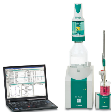
Figure 1. 905 Titrando con tiamo. Ejemplo de configuración para la determinación de vitamina C.
