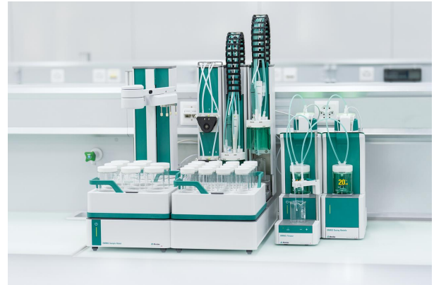
Figure 1. OMNIS Sample Robot S equipado con un valorador OMNIS, un módulo de dosificación OMNIS y dSolvotrode para la determinación automática de TAN y TBN en muestras de aceite de motor.
