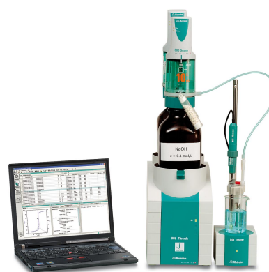
Figure 1. 905 Titrande con tiamo. Configuración de ejemplo para la determinación del título de ácido clorhídrico.
