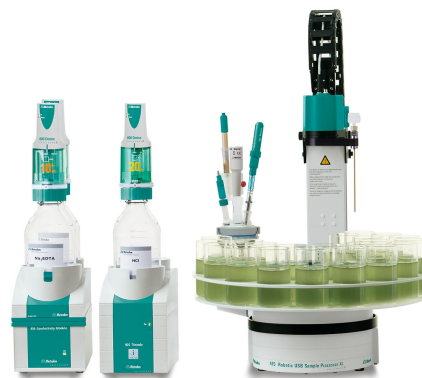
Figure 1. Ejemplo de configuración de un 815 Robotic USB Sample Processor XL con un recipiente de valoración externo, un 905 Titrand y un 856 Conductivity Module equipado con iAquatrode plus, Ca-ISE combinado, iAg-Titrode y celda de medición de conductividad de 5 anillos para el análisis de agua corriente .
