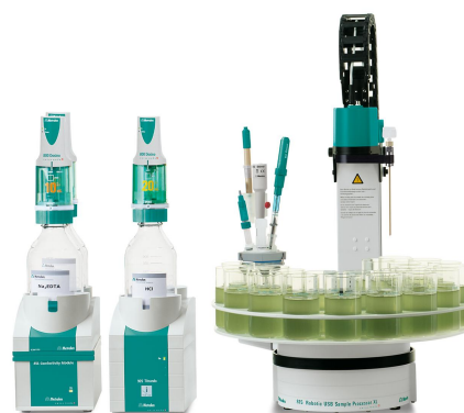
Figure 1. Sistema de ejemplo: 815 Robotic USB Sample Processor XL con recipiente de titulación externo, 905 Titrand y 856 Conductivity Module equipado con iAquatrode plus, iAg-Titrode y celda de medición de conductividad de 5 anillos para el análisis de agua corriente.
