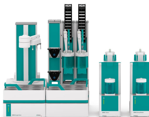
Figure 1. OMNIS Sample Robot S, OMNIS Dosing Module y OMNIS Advanced Titrator equipados con dProfitrode y dAg-Titrode para la determinación del contenido de cloruro.
