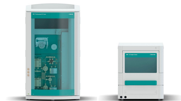
Figura 1 Configuración instrumental que incluye un 940 Professional IC Vario con un gradiente binario de alta presión y detección de conductividad después de la supresión química (L) y un 889 IC Sample Center – cool (R). El enfriamiento puede prolongar la estabilidad de la muestra.
