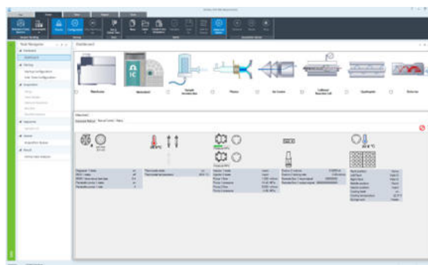
Figure 2. Con la ayuda del Metrohm IC Driver 1.0, ICP-MS MassHunter (6.6090.100), es posible el control total de ambos dispositivos (IC e ICP-MS) en ICP-MS MassHunter como una solución de software única.
