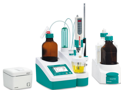
Figure 1. Titulador Eco KF equipado con un Polytron, una bomba de solvente y un electrodo de alambre de platino doble para la titulación volumétrica de Karl-Fischer.
