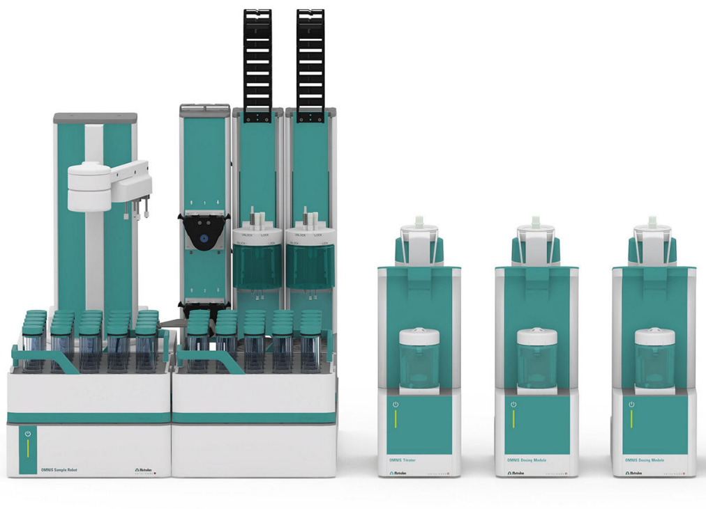
Figure 1. Sistema OMNIS automatizado para la titulación Karl Fischer volumétrica paralela y la titulación ácido-base acuosa que consta de un robot de muestras OMNIS, un módulo de dosificación OMNIS y un Titrator Professional OMNIS equipado con un electrodo de alambre de platino para sistemas automatizados y un dEcotrode plus.
