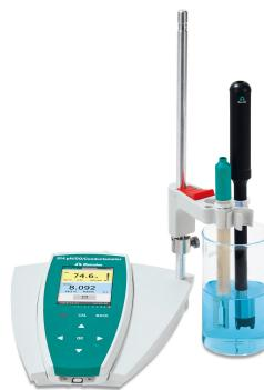
**Figure 1.** 914 pH/OD/Conductómetro equipado con O<sub>2</sub>-Lumitrode, celda de medición de conductividad e iUnitrode (falta en la imagen) para la determinación de DO, K (conductividad) y pH en productos lácteos líquidos.
