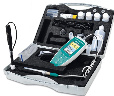
Figure 1. Maletín de transporte que incluye todos los accesorios y un conductómetro/pH/OD 914 equipado con un O 2 -Lumitrodo y un sensor de conductividad para la determinación del oxígeno disuelto en una corriente de agua dulce.
