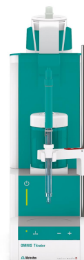
Figure 1. OMNIS Basic Titrator equipado con un electrodo selectivo de iones de cianuro para la determinación de cianuro en muestras de agua.
