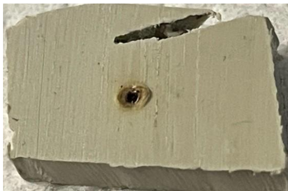
Figure 5. Ejemplo de quemado de muestra con un sistema de 1064 nm. Este material se identificó como éter de polifenileno (PPE) con MIRA XTR DS.
