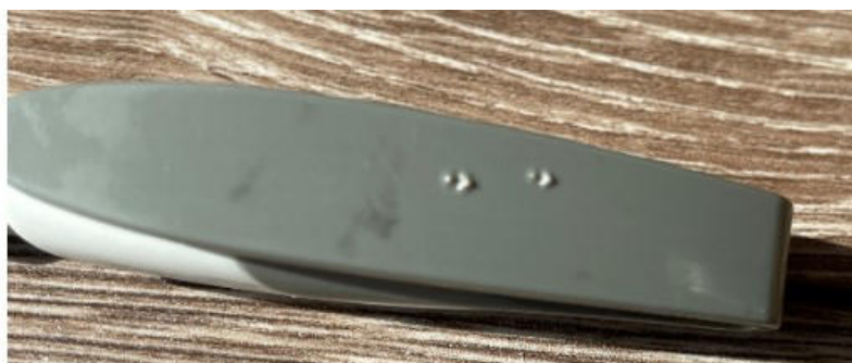
Figure 3. Bolígrafo de plástico gris, quemado con un sistema de 1064 nm e identificado como poliestireno con MIRA XTR DS.
