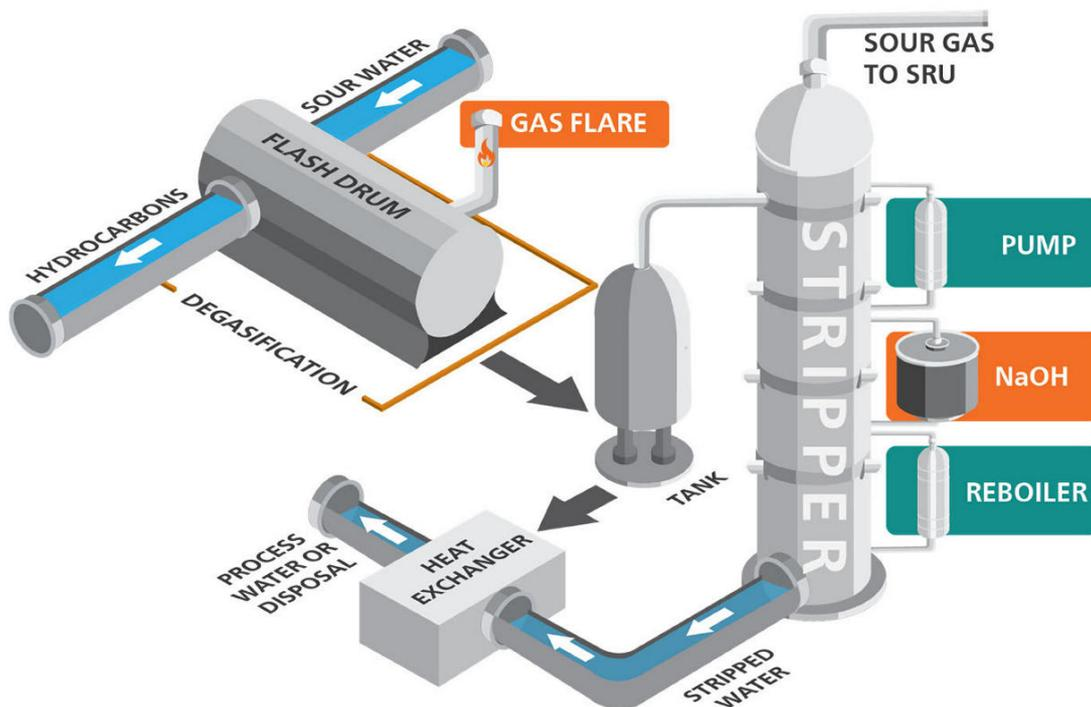
**Figure 1.** Esquema del proceso de stripping de aguas ácidas (SRU: Unidad de Recuperación de Azufre).
