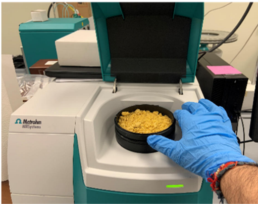
Figure 1. Muestra de macerado de fermentación colocada en el analizador de sólidos DS2500.
