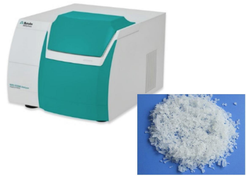
Figure 1. Se utilizó el analizador de sólidos DS2500 para recopilar los espectros del polímero de PVA.
