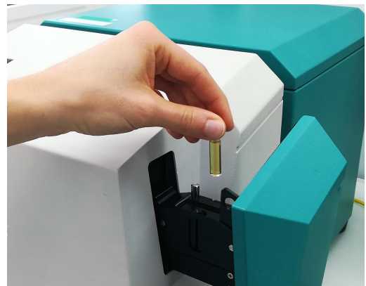
Figure 1. XDS RapidLiquid Analyzer y una muestra de polioli presente en un vial desechable de 4 mm.
