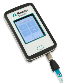
Figure 1. El instrumento DROPSTATPLUS y CASTDIR utilizados para conectar electrodos serigrafiados.
