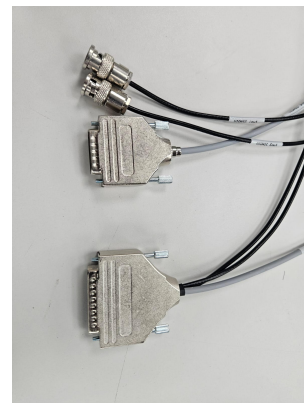
Figure 4. Disparador DIO y cable BNC utilizados en este sistema.
