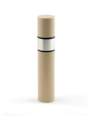
Figure 1. Electrodo de cilindro giratorio que muestra el inserto metálico, las juntas tóricas de Viton (negras) y el soporte de PEEK.
