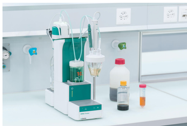
Figure 1.859 Configuración de Titrotherm para la titulación termométrica y la evaluación de datos realizada con tiamo.
