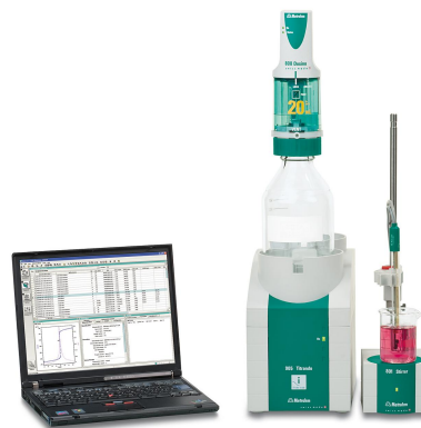
Figure 1. 907 Titrande con tiamo. Ejemplo de configuración para la determinación fotométrica de vitamina C.
