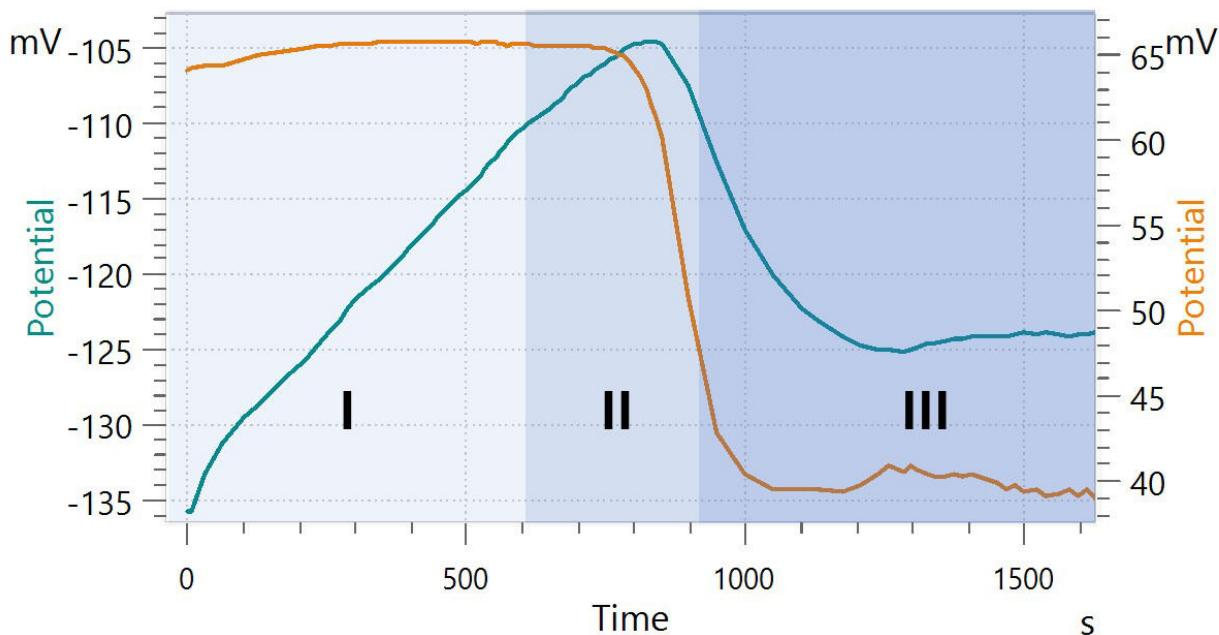
**Figure 2.** Curva de ejemplo para la formación de carbonato de calcio. En verde está el potencial de los iones de calcio libres medidos con el electrodo selectivo de iones de Ca combinado, y en naranja, el potencial medido con el Optrode. El experimento se llevó a cabo a pH 11. Las fases coloreadas describen la fase de prenucleación (I), la nucleación (II) y el crecimiento de partículas (III).
