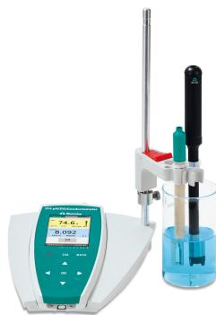
**Figure 1.** 914 pH/OD/Conductómetro equipado con un O<sub>2</sub>-Lumitrode y sensor de conductividad para la determinación de oxígeno disuelto en muestras de vino.
