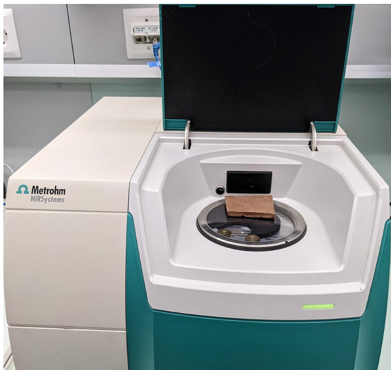
Abbildung 1. Metrohm NIRS DS2500 Feststoffanalysator mit einem Schokoriegel, der das Probenfenster abdeckt.
