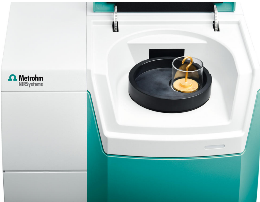
Abbildung 1. Metrohm DS2500 Solid Analyzer mit einem NIRS-Transflexionsgefäß anstelle eines Mini-Probenbechers.
