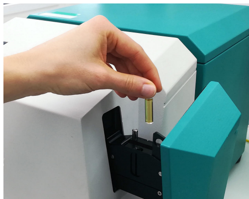
Abbildung 1. XDS RapidLiquid Analyzer und einer Palmölprobe, die sich in einem 8 mm Einweg-Vial befindet.
